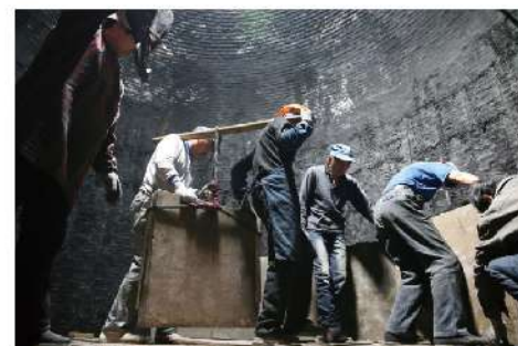
窑工们正在将晾了八个月以上的金砖泥坯装进土窑。这些砖坯要在窑炉中焙烧四个多月才能涸水出窑。
